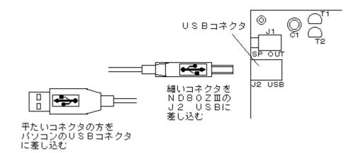
ケーブルがしっかりとそれぞれのコネクタに入っていることを確認してから、ND80ZⅢの電源を入れてください。 はじめてパソコンに接続したときのみ、USBデバイス用のドライバソフトウェアを組み込むためのメッセージが表示されます。
