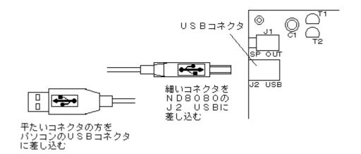
ケーブルがしっかりとそれぞれのコネクタに入っていることを確認してから、ND8080の電源を入れてください。 はじめてパソコンに接続したときのみ、USBデバイス用のドライバソフトウェアを組み込むためのメッセージが表示されます。
